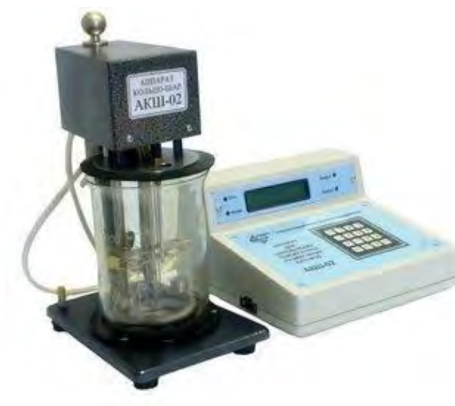
Рисунок 3 – Прибор для определения температуры размягчения битума по методу «кольцо и шар» АКШ-02
