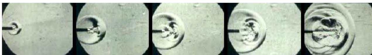
Рисунок 1 – Выход ударной волны и продуктов детонации за пределы края
